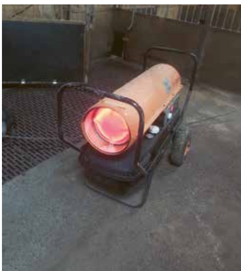
För att få tillräcklig upptorkning kan en flyttbar dieselkanon användas.
