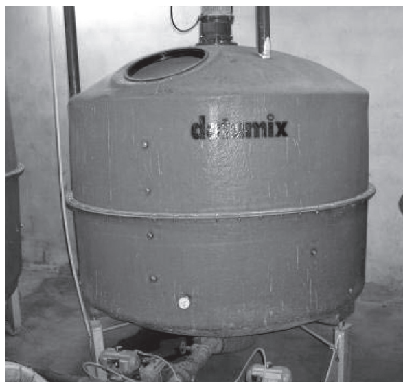
Bild 1) Fermenteringstank för spannmål som ingick som en del i tillväxtfodret (Gård A).
