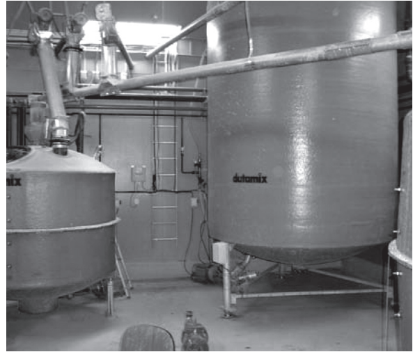
Bild 4) Utfodringstank för tillväxtgrisar till vänster och en stor fermenteringstank för spannmål höger om utfodringstanken (Gård B).
